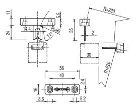
Figure 13.7: AC-AN-F1J2 actuator
