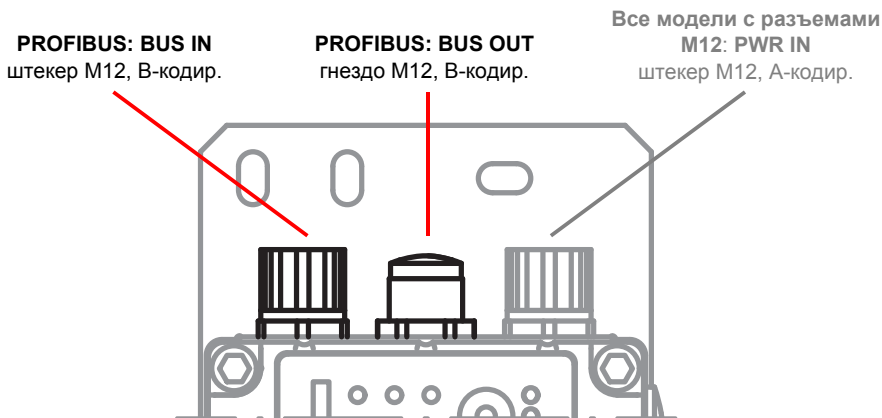
Рис. 5.4: Расположение и маркировка штекерных разъемов M12 для шины PROFIBUS
