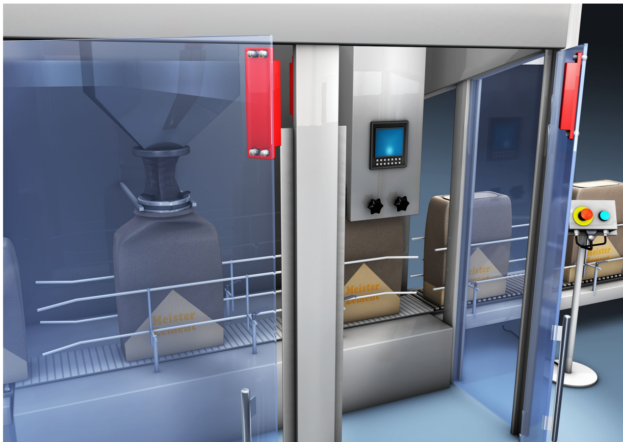
Рис. 5.2: Защита доступа на раздаточной установке, монтаж на дверях с датчиками MC388x
