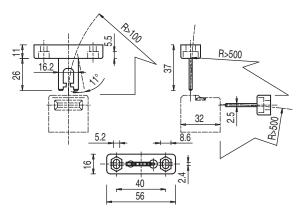
Figure 12.5: AC-AH-F1J2 actuator
