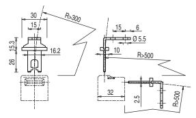
Figure 12.2: AC-AH-A actuator
