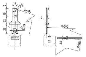
Figure 12.1: AC-AH-S actuator
