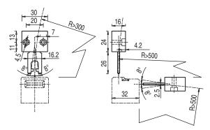
Figure 12.3: AC-AH-F4 actuator
