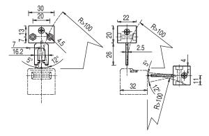
Figure 12.4: AC-AH-F2J2 actuator
